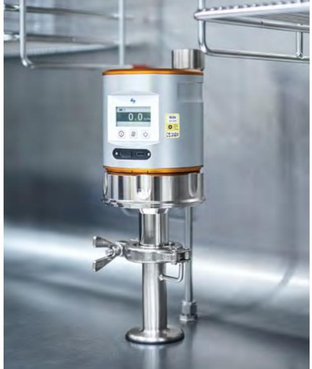
In jedem Fall stellen wir sicher, dass die Kalibrierung Ihres Luftkeimsammlers über das zertifizierte Digitalanemometer MAS-100 Regulus und über unser nach ISO 17025 akkreditiertes Kalibrierlabor auf internationale Standards zurückgeführt werden kann.
